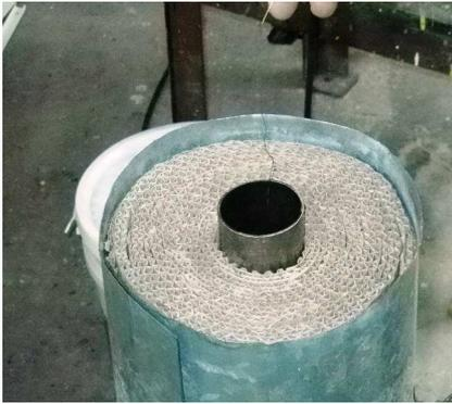
Fig. 3: Foto del dispositivo donde se observa el cartón corrugado, los dos tubos concéntricos, y la resistencia eléctrica central.
