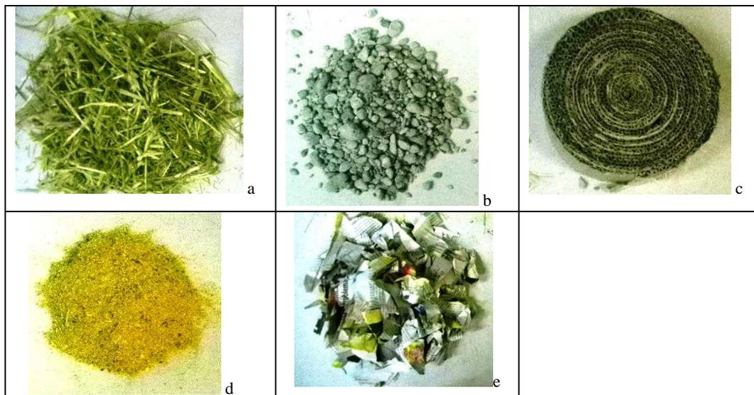
Fig. 4: materiales utilizados; a) paja de avena, b) Piedra pómez, c) Cartón corrugado, c) Aserrín de madera, e) papel de diario picado.
