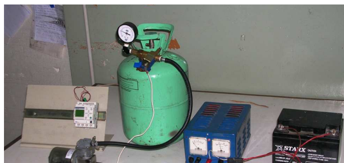
Figura 3: Elementos utilizados para el almacenamiento del biogás ya medido.
