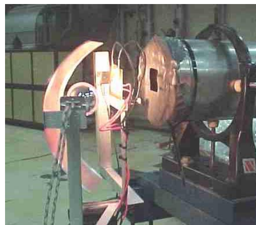
Figura 1. Esquema y foto del equipo utilizado en la irradiación en la línea externa del acelerador Tandar del Centro Atómico Constituyentes de la CNEA.
