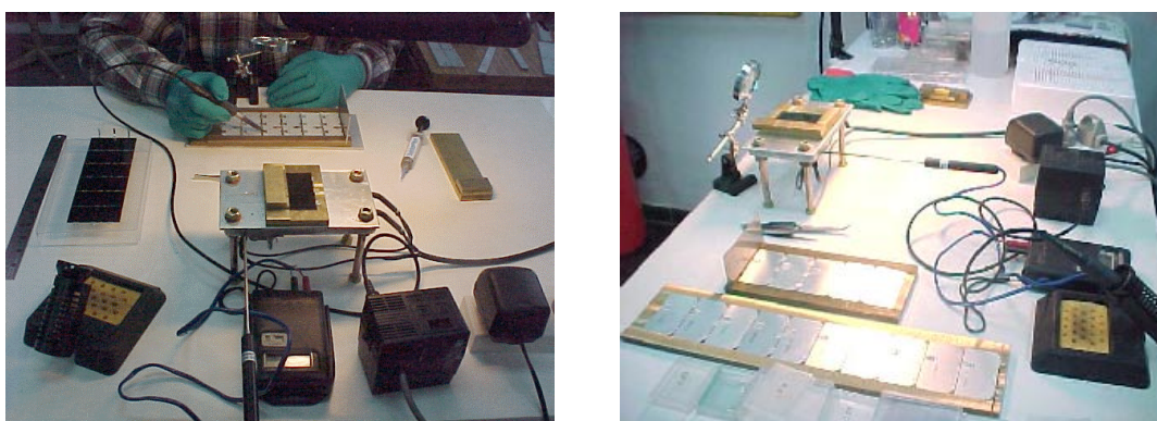
Figura 3: Dispositivos de alineación para soldadura de cadenas de celdas en serie.
